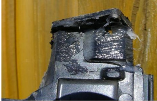
Wasserablaufleiste außen großzügig mit Fett versehen, da kommt man nach dem Einbau nur schlecht ran.
