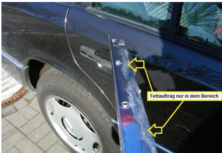
Diese Markierung ist später noch wichtig für die Überprüfung der Grundeinstellung
